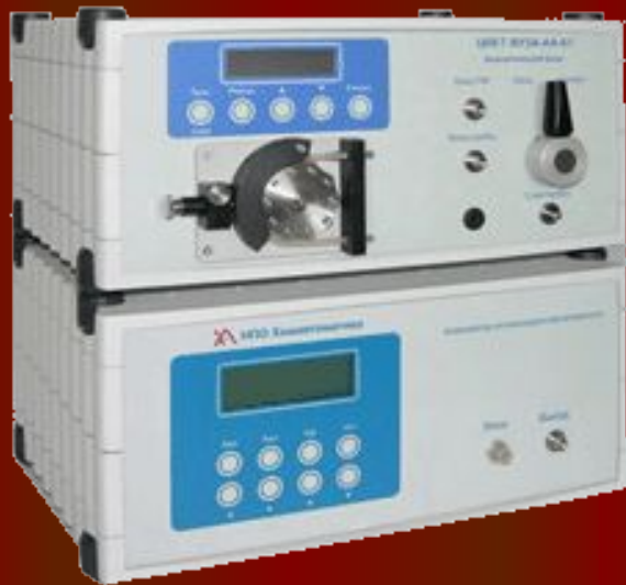
ПРИБОР «ЦВЕТ ЯУЗА» ДЛЯ ОПРЕДЕЛЕНИЯ АНТИОКСИДАНТНОЙ АКТИВНОСТИ АМПЕРОМЕТРИЧЕСКИМ МЕТОДОМ
